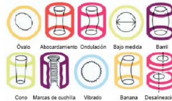
Hay 10 errores comunes en los orificios que se producen al mecanizar, amarrar o tratar térmicamente. Todos ellos pueden corregirse fácil y rápidamente con la bruñidora Sunnen MBB-1660.
